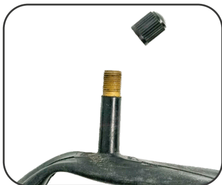
Ilustracja 16. Zawór „Schradera” (samochodowy)
