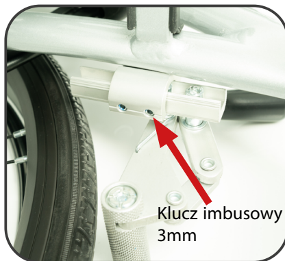
Ilustracja 12. Regulacja hamulca.
